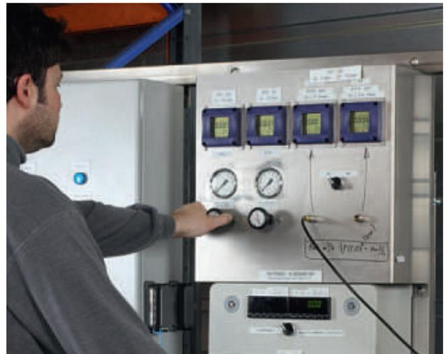
Sämtliche Druckregler werden auf unserem Prüfstand auf Funktion getestet und auf die Prozessdaten eingestellt. Vor dieser Funktionskontrolle werden die Druckregler auf Dichtheit nach aussen geprüft. Für jeden produzierten Regler werden die Leistungsdaten und die Reglercharakteristik erfasst.
